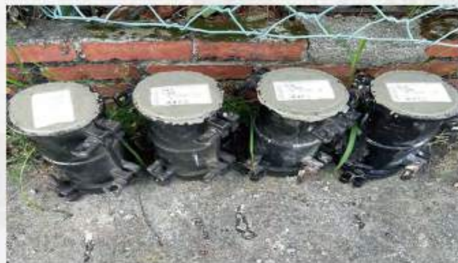
混凝土材料現場取樣 製作抗壓試體
